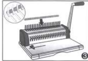
3. 천공핸들이 수직이 되도록 한 다음 제본틀에 플라스틱링을 걸어줍니다. (링이 열리는 부분이 위로 향하게, 고리가 제본기 뒤를 향하게 걸어줍니다.)
