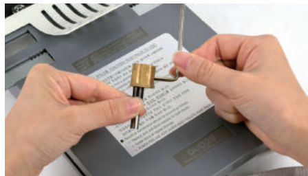
6. 육각렌치를 이용하여 몽치와 날을 분리한 후 새로운 날을 몽치에 결합시킨 후 역조립 해 주세요.
