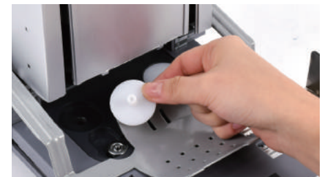
2. 디스크를 손으로 들어올려 빼주고, 새 디스크로 교체해 줍니다. (디스크를 돌려가며 사용하세요)
