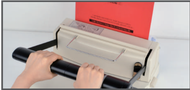
6. 와이어 압착홈에 링을 끼운 원고를 아래로 향하게 넣고 핸들을 내려 와이어를 압착하면 제본이 완성됩니다.
