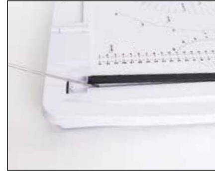
1. 작은 드라이버를 이용해 재단목 가장자리 홈 부분에 끼워서 재단목을 들어올려줍니다.
