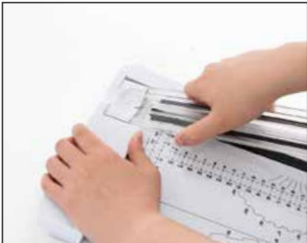
5. 칼날을 교체해준 후 위의 과정을 반대 순서로 가이드레일을 재단기에 조립해줍니다.
