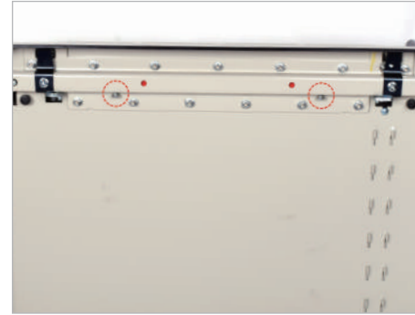
③ 재단목이 있는 밑판에 나사 2개를 느슨하게 풀어줍니다. (*재단목이 딱딱해서 빠지지 않을 때 해줍니다.)
