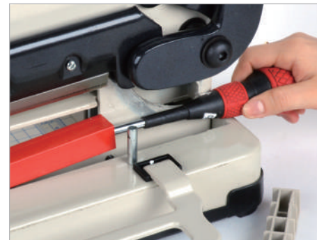
④ 드라이버를 이용하여 재단목을 들어올려 빼준 후 사용하지 않은 면으로 바뀌어서 교체해줍니다.
