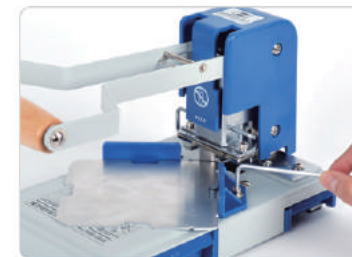
④ 파란색 가이드를 조정해준 후 느슨했던 나사를 다시 유각렌치로 조여서 고정시켜줍니다.
