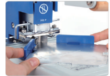
③ 얼라이먼트를 이용하여 해당 사이즈에 날과 맞춰준 상태에서 파란색 가이드를 조정해줍니다. (*해당 날에 얼라이먼트 사이즈가 적혀있습니다.)
