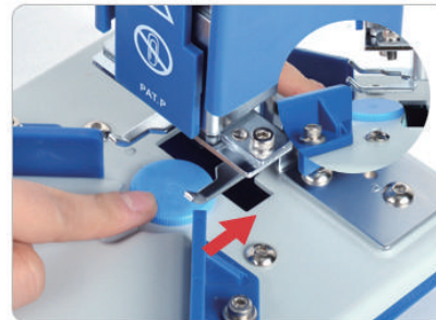
② 새 디스크를 넣고 뒷부분을 누른채로 딸깍 소리가 나면서 맞물려질때까지 끝까지 밀어 넣어줍니다.
