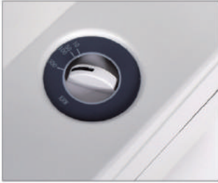
⑥ 동전두께에 맞게 동전두께레버와 동전권중레버를 조절합니다. 권중이 섞여있을 시 금액이 큰 동전을 기준으로 맞춰주세요.
