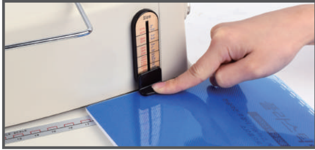
4. 제본두께 조절가이드에 제본할 종이를 대고 사진과 같이 레버를 내려 링 사이즈를 측정합니다.
