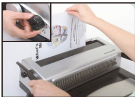
5. 와이어링 열린부분이 바닥으로 향하도록 와이어링압착홀에 넣은 후 와이어링 규격레버를 링크기에 맞게 조절한 후 제본핸들을 내려주세요.
