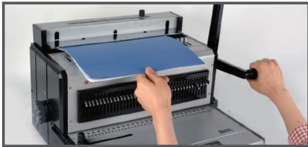
6. 압착부에 링을 끼운 원고를 넣고 제본핸들을 앞으로 당겨 와이어를 압착하면 제본이 완성됩니다.
