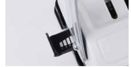
2. 천공마진을 원하는 위치로 설정해 줍니다. (숫자가 높을수록 천공마진이 넓어집니다.)
