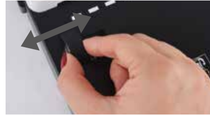
1. 제본할 서류를 준비한 후 제본할 용지에 맞도록 용지규격레버를 설정합니다.
