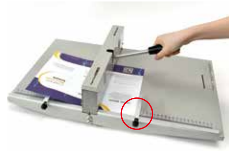
3. 인쇄물의 바깥 면을 아래로 향하게 하여 투입구에 넣어준 후 용지 끝을 가이드에 걸쳐주고 조작 핸들을 내려 오시선을 만들어 줍니다.
