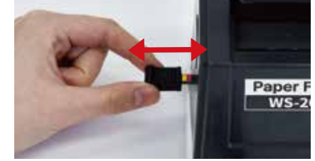
2. 좌측의 천공마진 조절레버를 원하는 위치로 설정해줍니다. (비갈으로 당길 수록 넓어집니다.)
