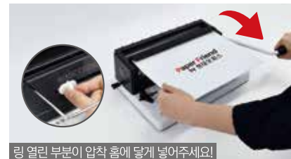
5. 링 사이즈에 맞춰 링규격을 조절한 후 제본할 문서를 와이어링 압착부에 넣고 핸들을 내려 링을 압착 시켜줍니다.
